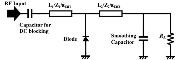
**Fig. 4.** Rectifier circuit for evaluation
