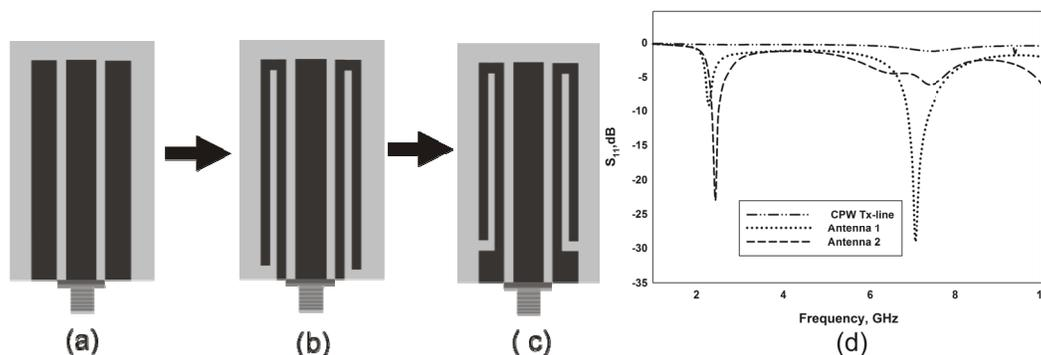
Figure 2 Antenna Evolutions (a) CPW Tx-Line (b) Antenna 1 (c) Antenna 2 (d) Reflection characteristics
